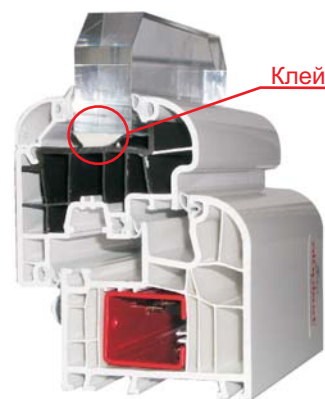
Поперечное сечение профиля с клееным стеклом (приклеивание в фальц створки)
