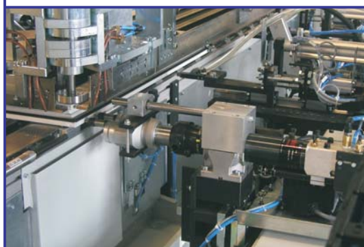
Schraubeinheit und Bohrregat zur Montage der Flügellager
