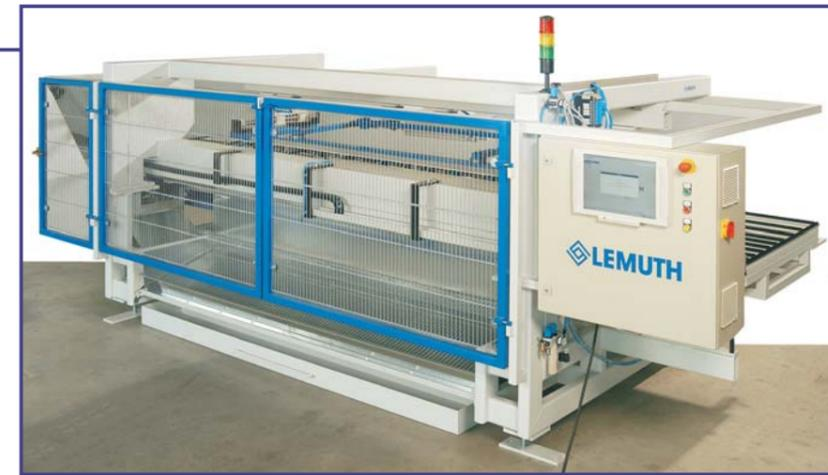
Der Ein- und Austransport der Teile erfolgt vollautomatisch. Für Positionierfahrten und Transport kommen Richtungsachsen zum Einsatz.
